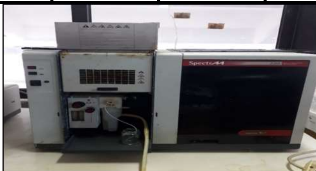
الشكل (2): صورة تظهر جهاز امتصاص الطيف الذري نوع Varian 220
