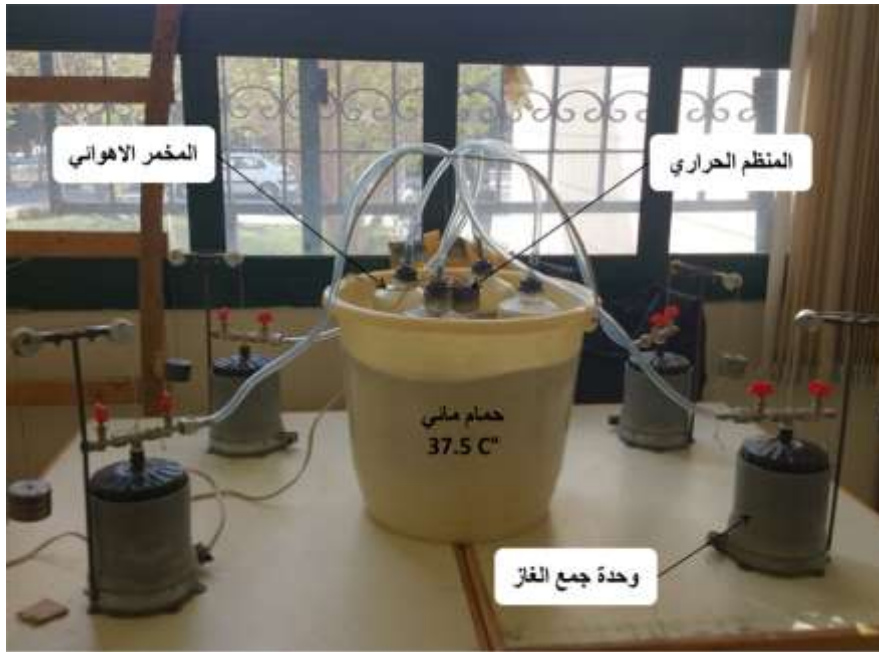
الشكل (2): وحدة التخمر اللاهوائية المخبرية المستخدمة في التجربة
