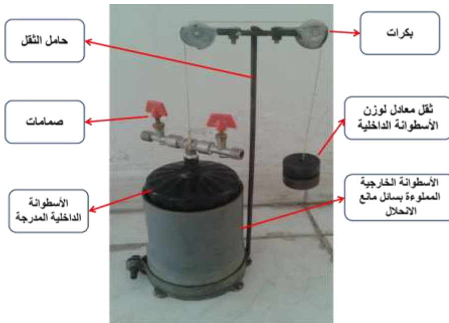
الشكل (3): وحدة جمع الغاز المستخدمة في التجربة
