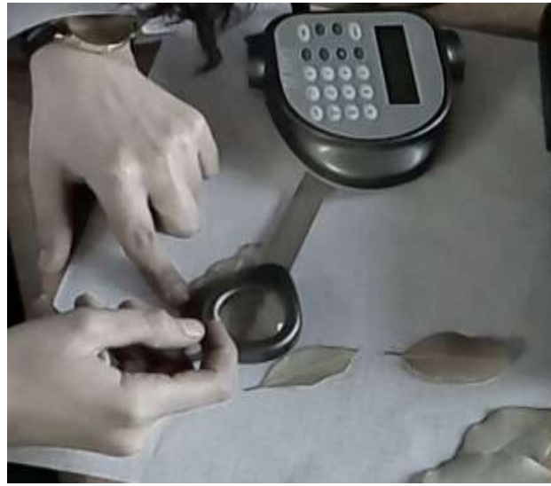
الشكل (1): جهاز البلانومتر لقياس مساحة نصل أوراق الغار.
