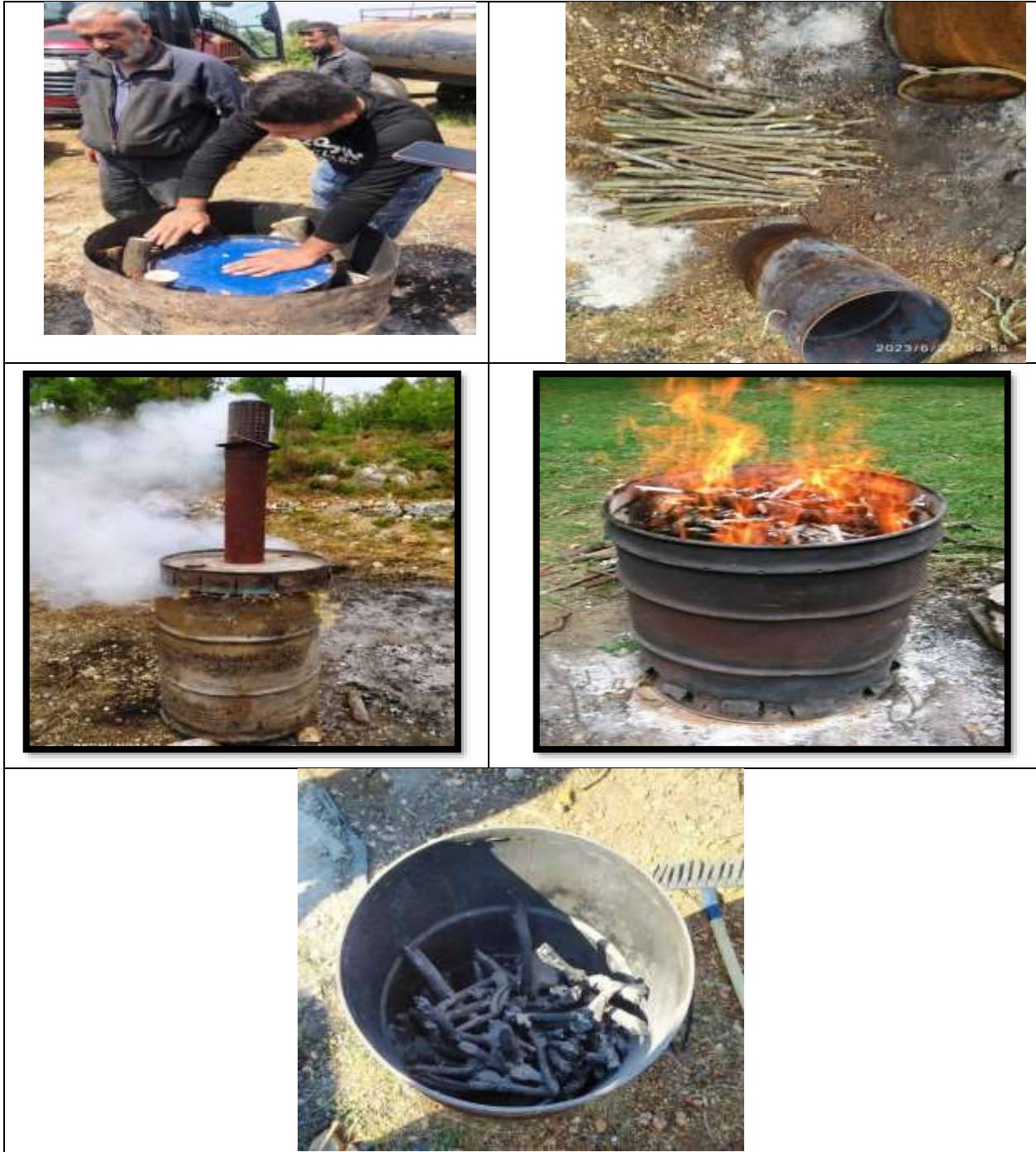
الشكل (2): مراحل التفحيم بطريقة البراميل المزدوجة
