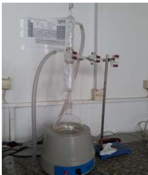
الشكل (3): جهاز Soxhlet
