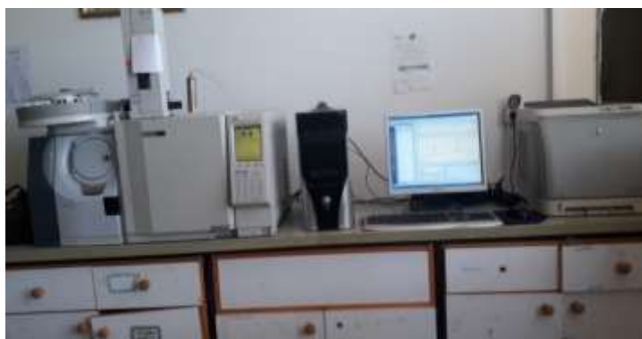
الشكل (4): جهاز GC/MS الكروماتوغرافيا الغازية المقرون مع مطيافية الكتلة
