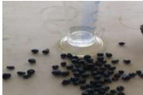
الشكل (7): يوضح طريقة قياس حجم الثمار بواسطة الأسطوانة المدرج
