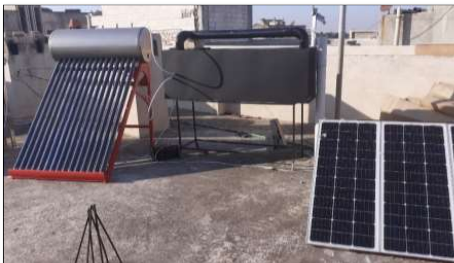
شكل(2) المجفف الشمسي الهجين المستخدم في البحث
