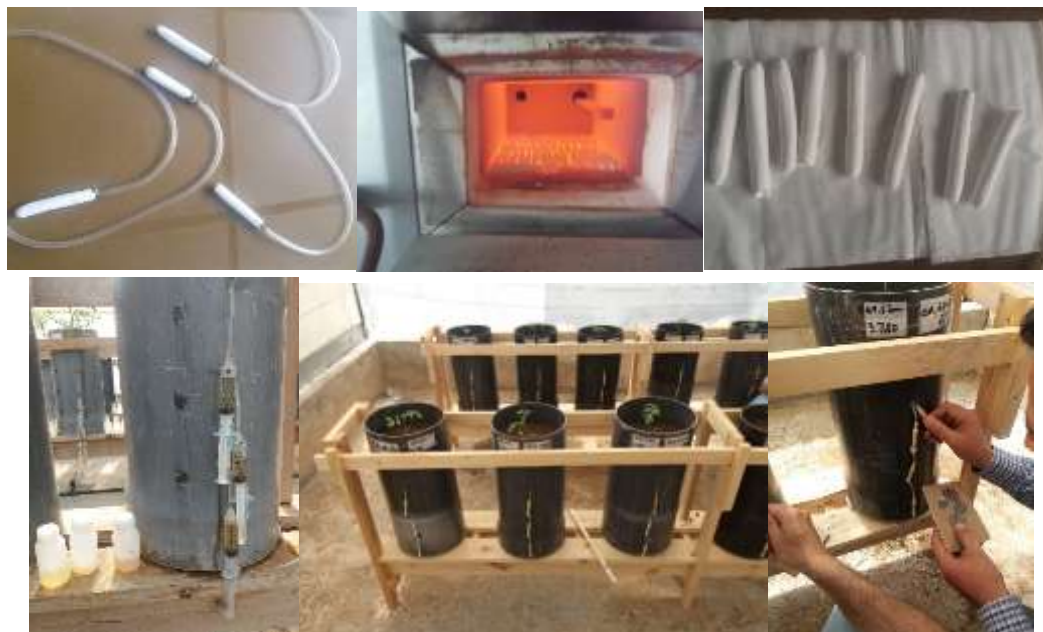
الصورة (1): مراحل تصنيع الليزومتترات (Lysimeter) في المختبر.
