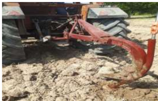
الشكل (1): المفك الميكانيكي مع أنبوب الضخ المثبت في نهايته حتى عمق الحراثة
