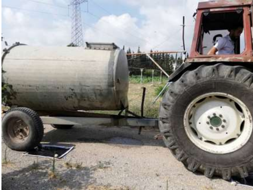
الشكل (3): يوضح آلية حساب مساحة سطح التماس للعجلة
